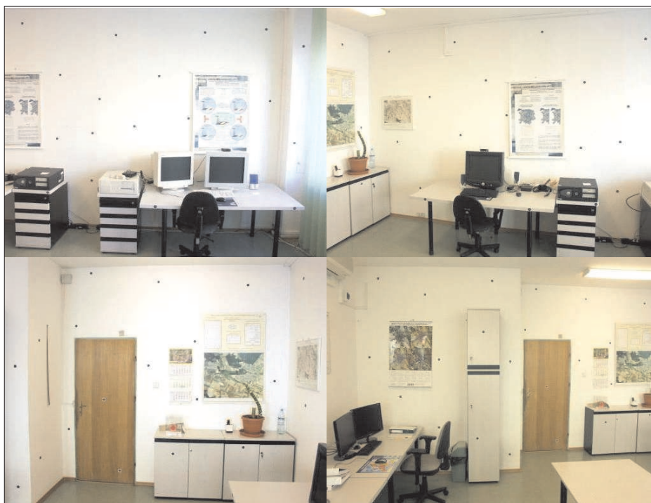
Rys. 4. Rozmieszczenie punktów osnowy pomiarowej w pomieszczeniu testowym
