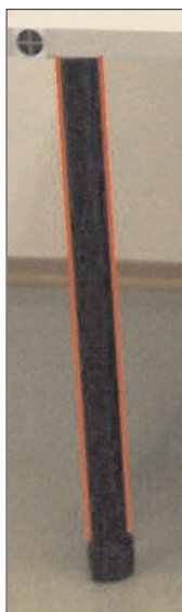
Rys. 6. Sposób wyznaczania linii bocznych przekroju walca
